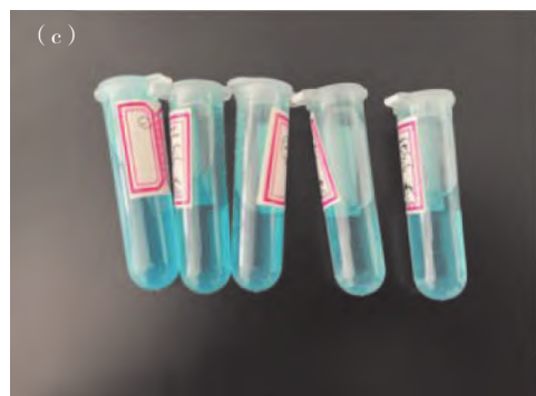
图3 (a) \text{H}_2\text{O}_2 浓度对 CDSn 光催化活性的影响； 实物降解图：(b) 加入 \text{H}_2\text{O}_2 的实验组， (c) 未加入 \text{H}_2\text{O}_2 的对照组
