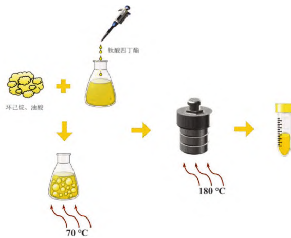
图 1 纳米 TiO 2 合成流程图
