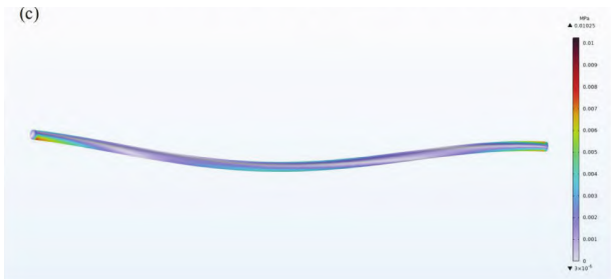
(c) 光纤单元应力分布云图
