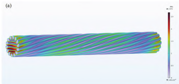
(a) 钢丝铠装层应力分布云图
