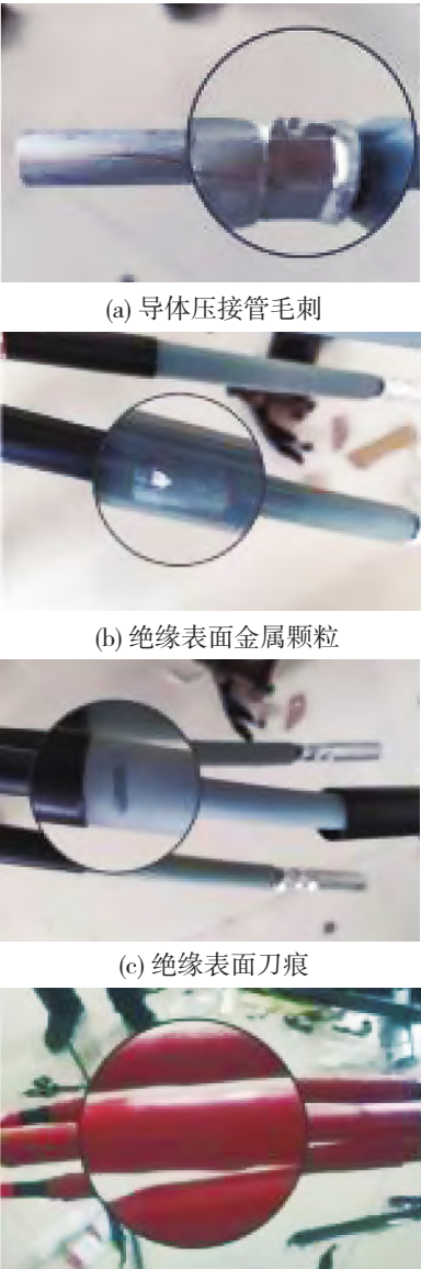
图 2 含工艺缺陷的电缆接头样品
